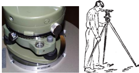
شکل ۶-۸- تراز نمودن تراز کروی با پایه‌ها
