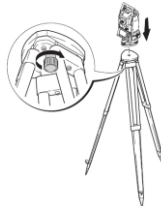
شکل ۶-۷- نحوه قرار دادن دوربین بر روی سه پایه
